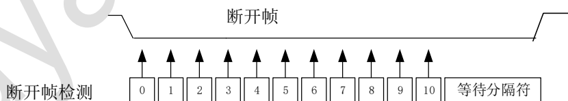
图 31-19 LIN模式下的断开帧长度够的情况
